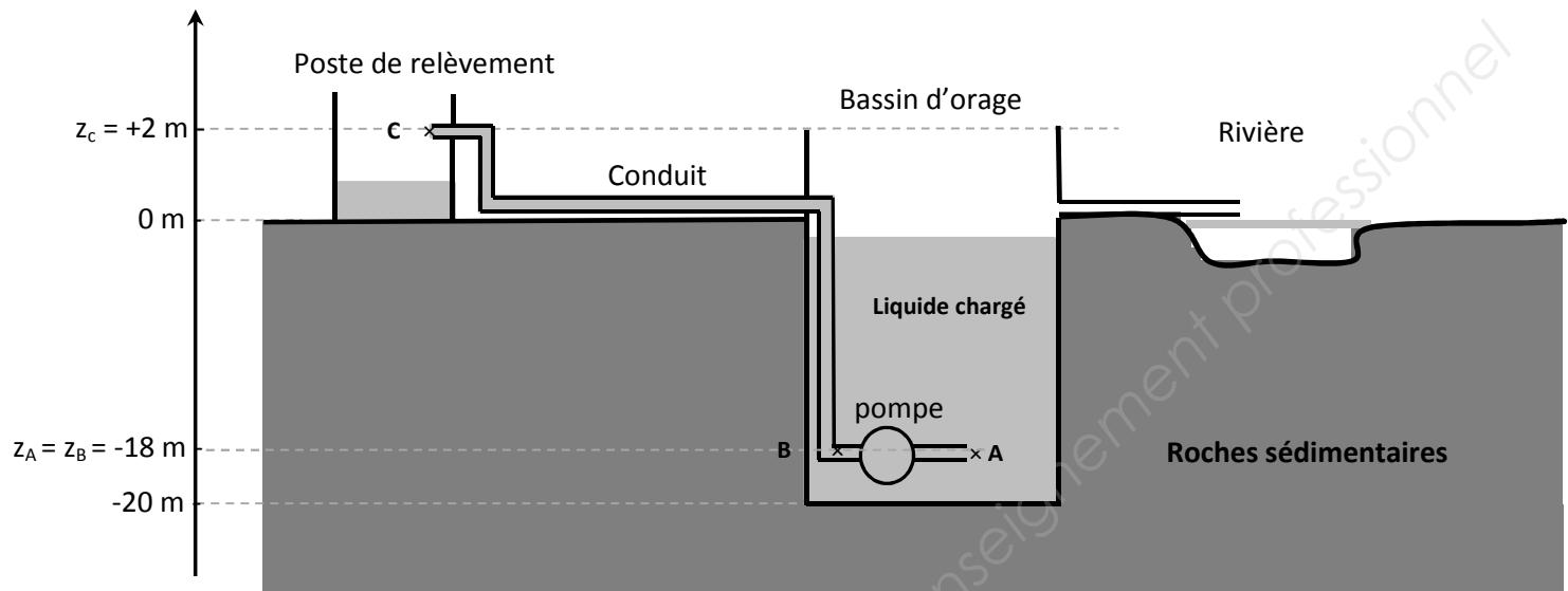
Le bassin d'orage de forme cylindrique, a un diamètre égal à 40 m et une profondeur de 22 m. Pour des raisons techniques, celui-ci peut être rempli au maximum jusqu'à 20 m de hauteur.
