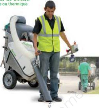
Cet outil de propreté est capable d'aspirer la plupart des déchets encombrant les trottoirs et caniveaux.
